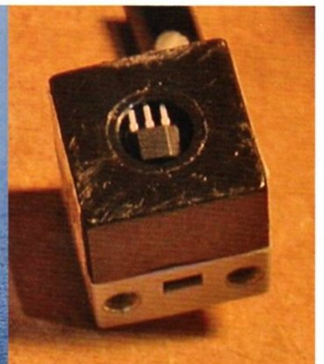
Selbst gebauter Hall-Effekt-Sensor zur Reaktion auf Magnet-Felder. Siehe auch Artikel im Clubblatt 2007-1.
