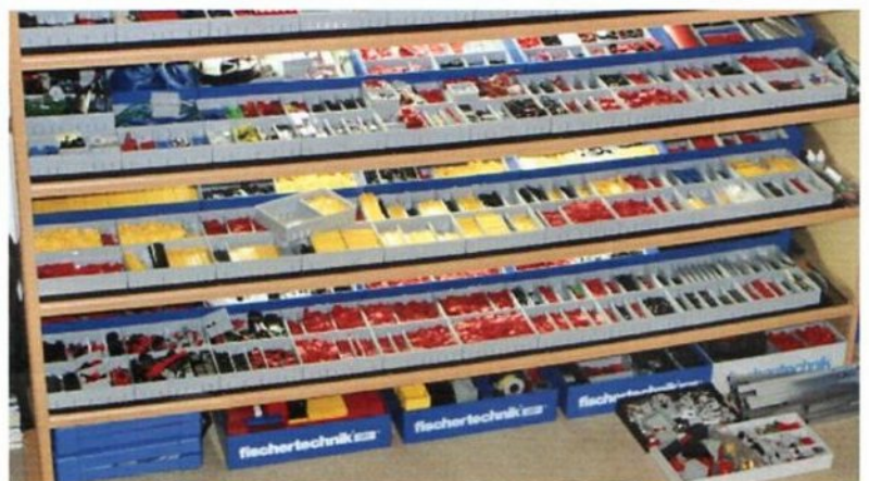
Oben: Johan Lankheet hat selbst ein Lagersystem gebaut, wobei die Teilungen der Schubfächer nach Wahl kleiner oder größer gemacht werden können.
